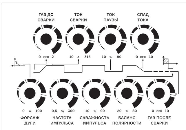
**Газ до сварки.** Таймер предназначен для установки времени предварительной продувки газа.
