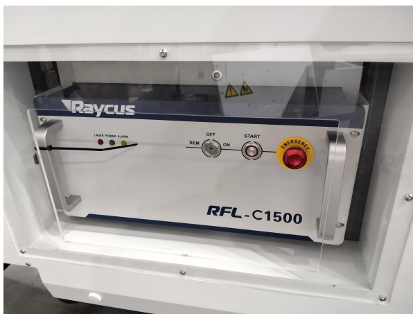
Кнопка аварийной остановки на источнике лазерного излучения (Внимание! Марка и модель излучателя могут отличаться от представленных на фото)
