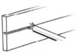
Рисунок 13. Горизонтальное положение при сварке
