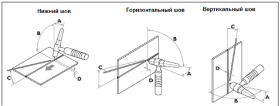
Рисунок 18. Базовые движения при работе с аргодуговой горелкой
