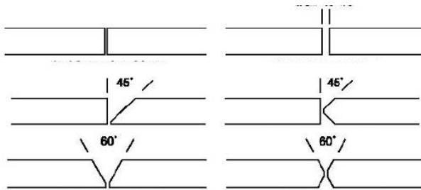
**Рисунок 5. Стыковые соединения**
